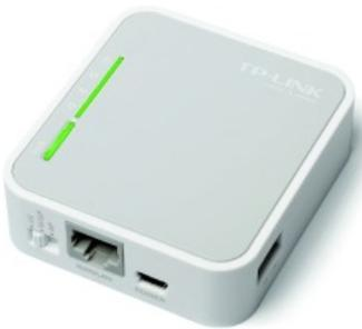
TP-Links TL-MR3020 bringt 4 MByte Flash und 32 MByte RAM mit, was für eine Sparversion der freien Firmware OpenWRT ausreicht.
